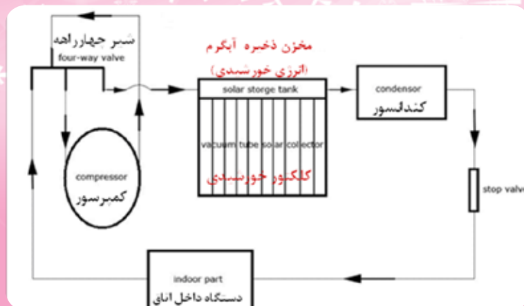
شکل ۳- شماتیک سیکل کولر گازی برقی - خورشیدی :
